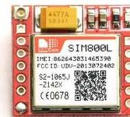
Gambar 2.8 Bentuk Fisik Modul *GSM SIM800L*
