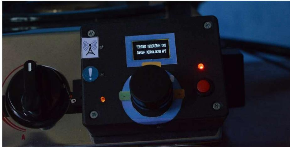
**Gambar 4.14** Tampilan terjadi kebocoran gas
