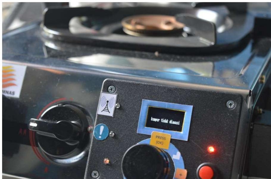
**Gambar 4.13** Tampilan kompor dimatikan otomatis
