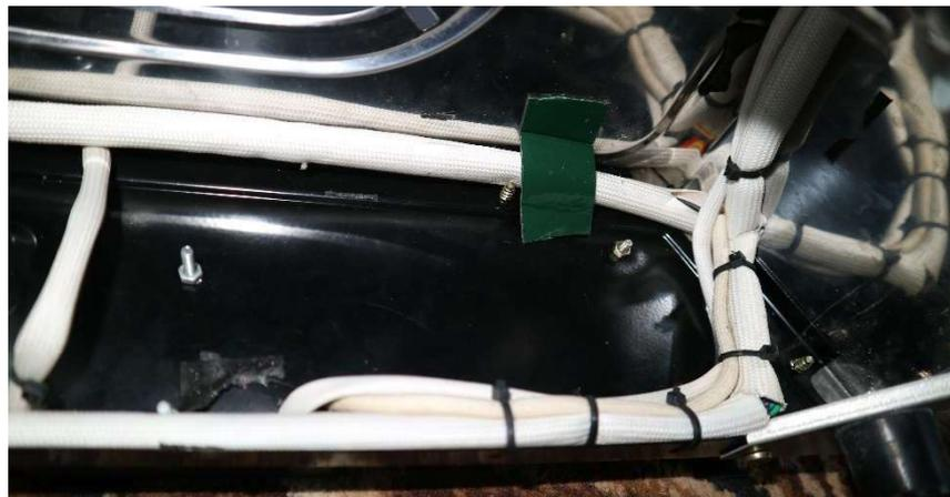
**Gambar 3.30** Pengkabelan menggunakan slongsong asbes
