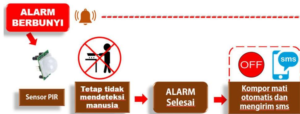
**Gambar 3.7** Blok diagram kompor mati otomatis
