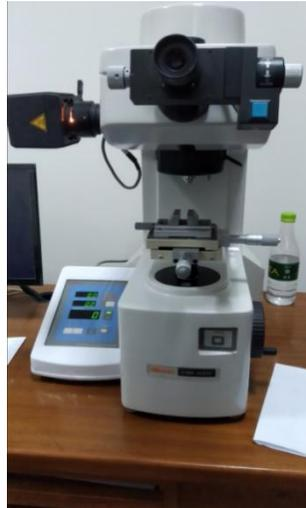
Gambar 3.3 Mesin Uji Kekerasan
