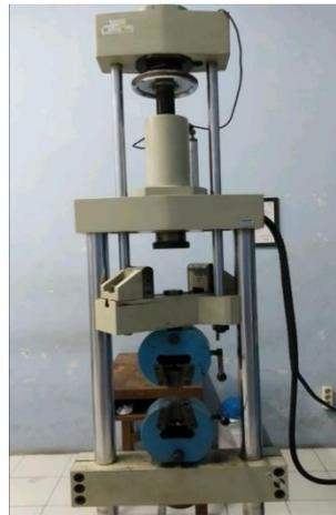
Gambar 3.2 Mesin Uji Tarik Tipe TN 20 MD
