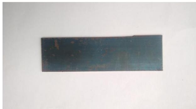
Gambar 3.6 Baja Karbon Tinggi SK 5 ukuran 80 ml x 25 ml
