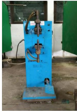
Gambar 3.1 Mesin Las Titik tipe DN-16-1
