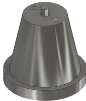
Gambar 4.56 Gambar 3D insert core ukuran sedang
