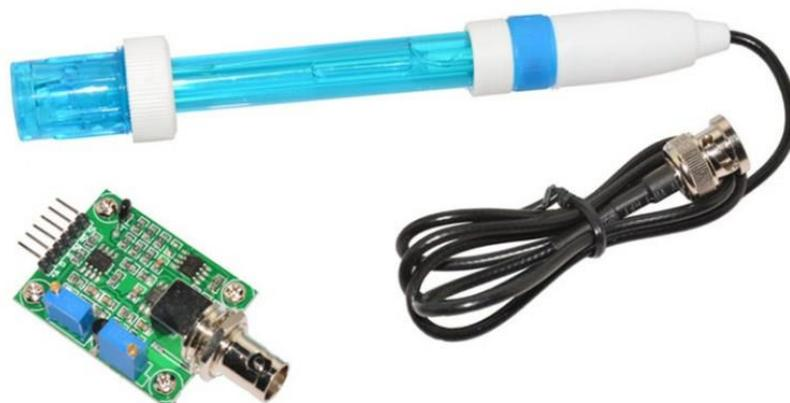
Gambar 2.3 Elektroda Tipe pH E-201 dan Modul pH E-201 [9]
