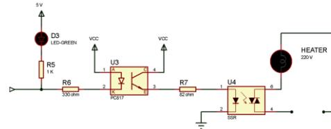
Gambar 3 Rangkaian *Driver heater*
