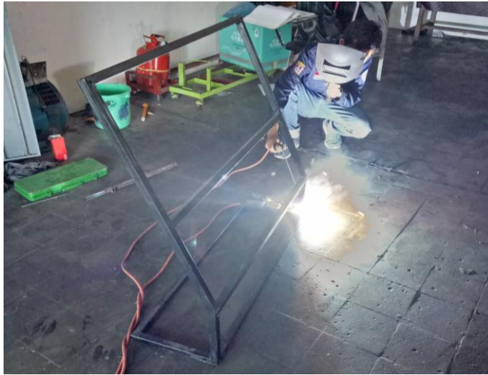
Gambar 4.5 Proses Pengelasan Bagian Rangka
