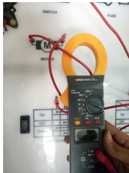
Gambar 4.32 Hasil pengujian motor power window dari saklar utama untuk penumpang pada saat turun
