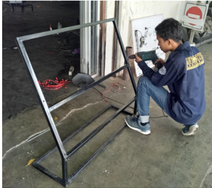
Gambar 4.9 Proses Pengeboran Lubang pada Rangka
