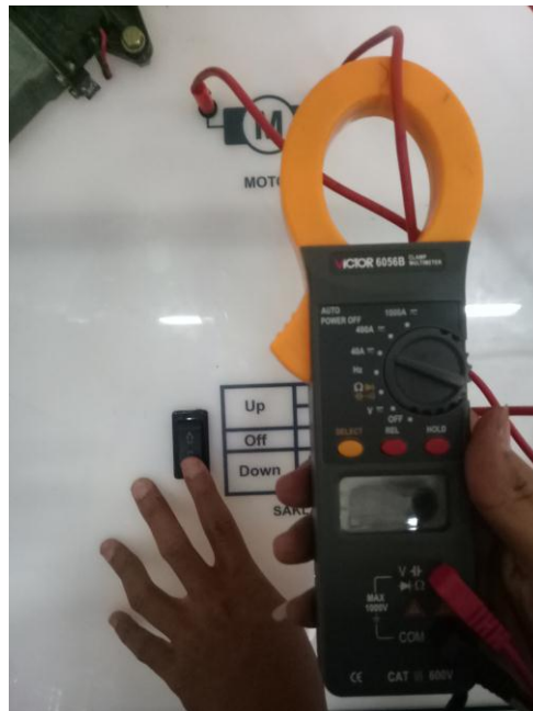
Gambar 4.35 Hasil pengukuran motor power window saklar Penumpang pada saat turun
