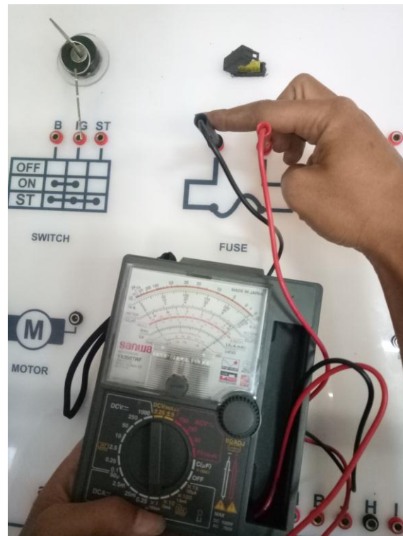
Gambar 4.21 Pengecekan Kontinuitas Fuse
