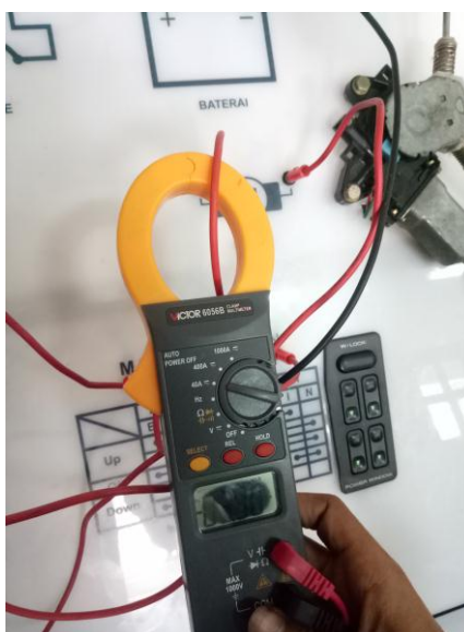
Gambar 4.31 Hasil pengukuran motor power window pengemudi pada saat naik
