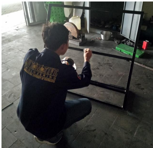
Gambar 4.7 Proses Pengecatan Rangka
