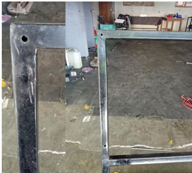
Gambar 4.10 Hasil Pengeboran Lubang pada Rangka
