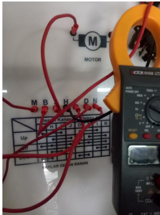
Gambar 4.30 Hasil pengukuran motor power window pengemudi pada saat turun
