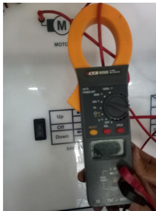
Gambar 4.34 Hasil pengukuran motor power window saklar penumpang pada saat naik
