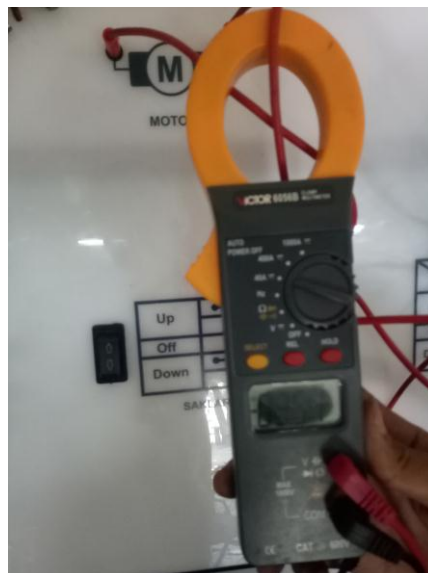
Gambar 4.33 Hasil pengujian motor power window dari saklar utama untuk penumpang pada saat naik
