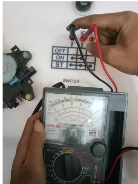
Gambar 4.22 Pengecekan Konitunitas Kunci Kontak
