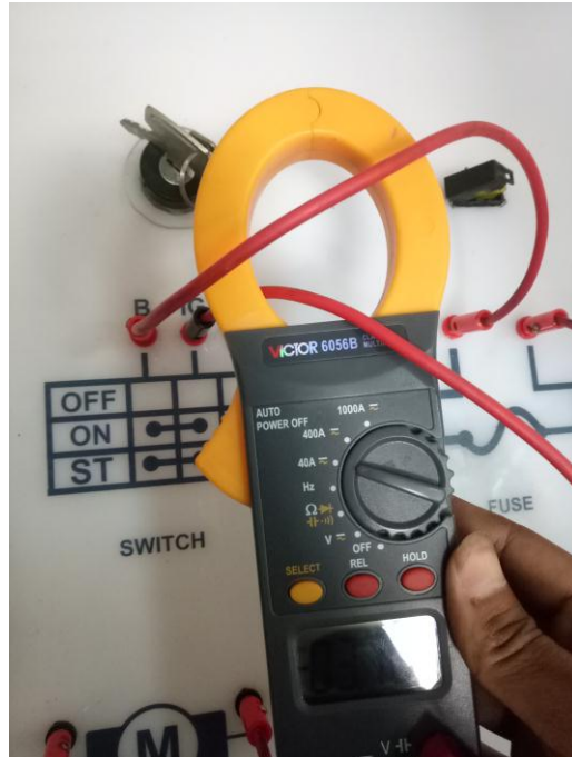
Gambar 4.29 Pengukuran Arus Yang Keluar Dari Kunci Kontak
