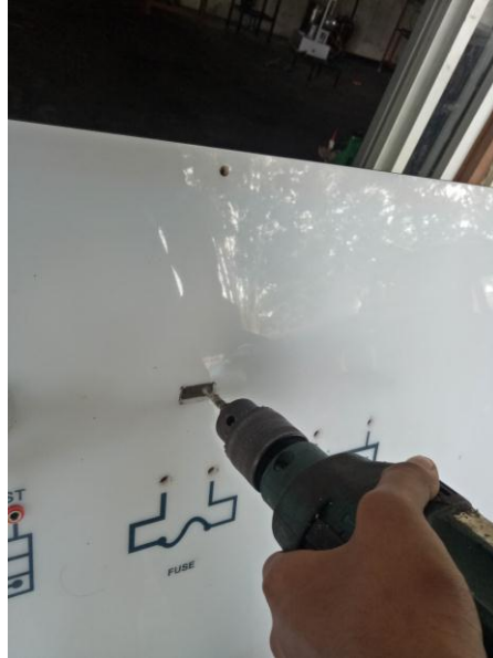
Gambar 4.14 Proses Pembuatan Lubang Fuse
