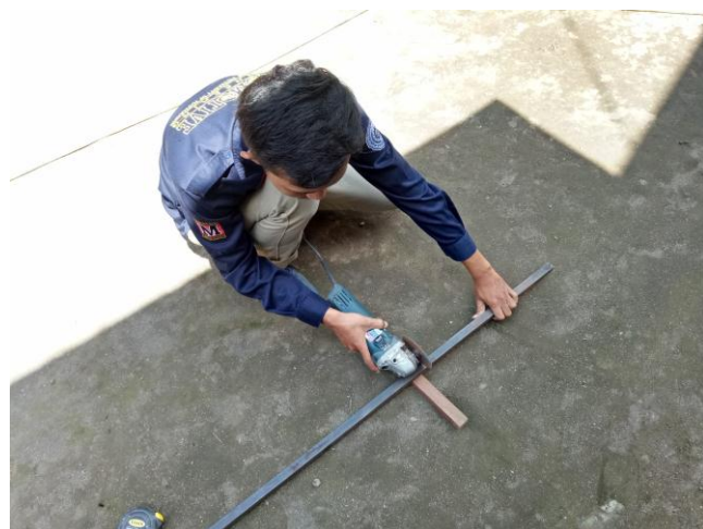
Gambar 4.4 Proses Pemotongan Besi
