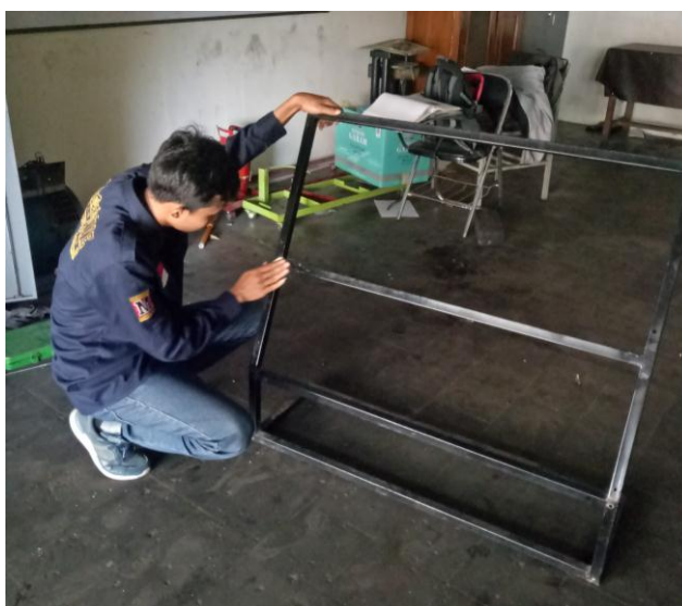
Gambar 4.6 Proses Pengamplasan Rangka
