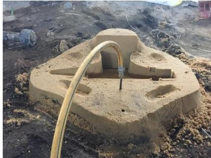
**Gambar 4.3** proses pemberian gas CO<sup>2</sup> sebagai media pengerasan pada cetakan pasir kering. (Sumber CV. Kembar Jaya, 2019)
