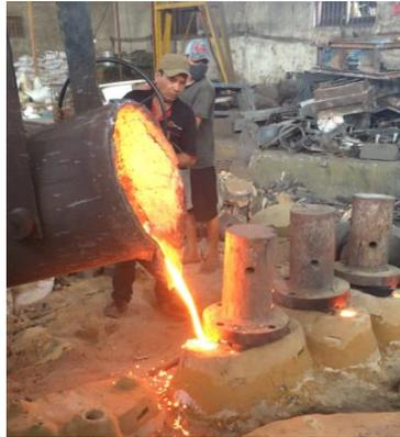
**Gambar 4.7** Proses penuangan cairan logam. (Sumber CV. Kembar Jaya, 2019)
