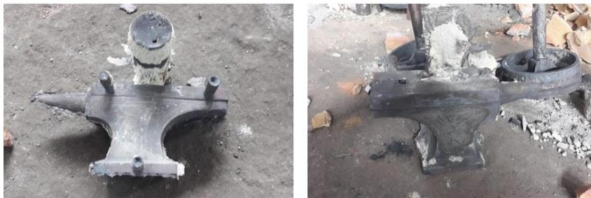
**Gambar 4.8** Proses pembongkaran material dari cetakan. (Sumber CV. Kembar Jaya, 2019)
