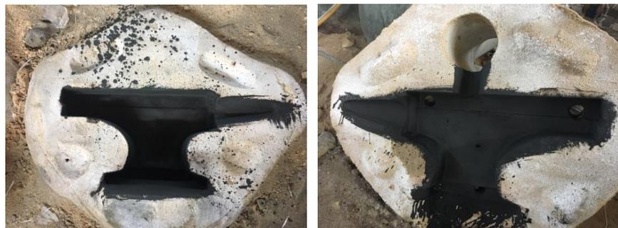
**Gambar 4.4** Proses coating pada dinding cetakan pola. (Sumber CV. Kembar Jaya, 2019)
