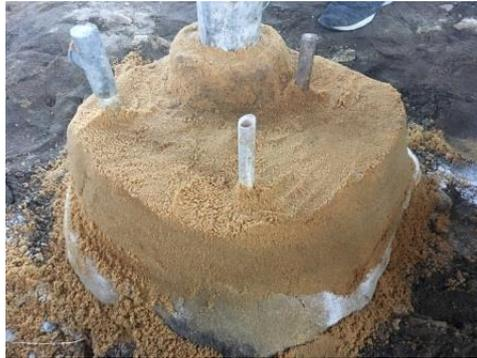
**Gambar 4.5** Proses penggabungan cetakan bawah dan cetakan atas. (Sumber CV. Kembar Jaya, 2019)
