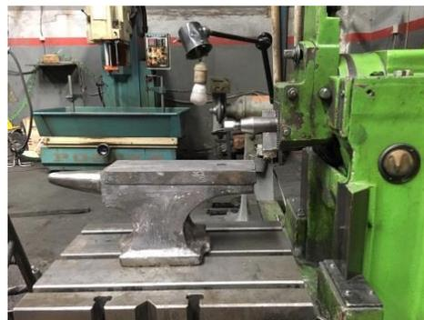
**Gambar 4.10** Proses Meratakan landasan paron menggunakan mesin sekrap (*shaping machine*). (Sumber Jasa Tech 2019)
