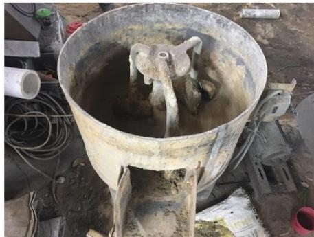
**Gambar 4.1** Mesin Pengaduk Pasir (Sumber CV. Kembar Jaya 2019)
