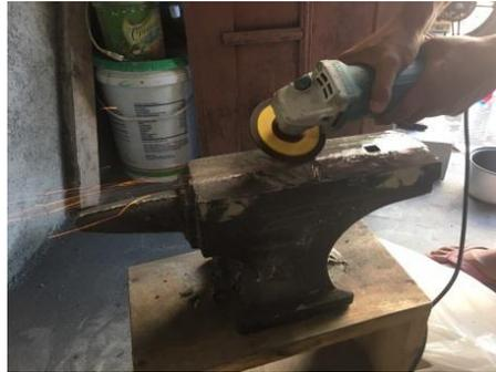
**Gambar 4.9** Proses pemotongan saluran masuk logam cair. (Sumber CV. Kembar Jaya, 2019)
