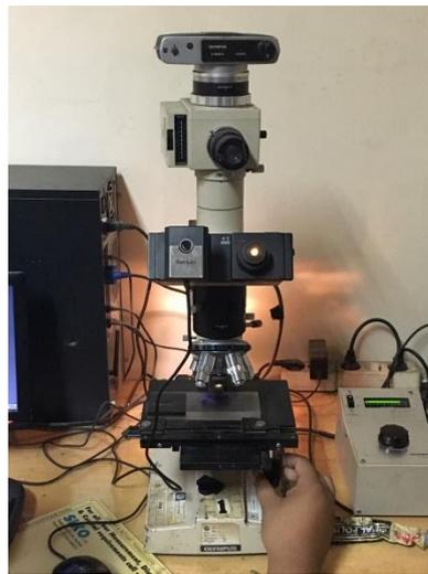
**Gambar 2.7** Alat uji struktur mikro. (Sumber laboratorium bahan teknik
