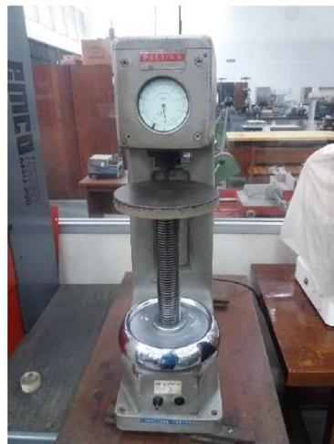
**Gambar 2.5** Mesin pengujian kekerasan Brinnel
