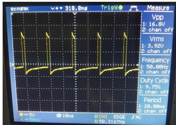
Gambar 4.5 bentuk gelombang frekuensi 50 Hz
