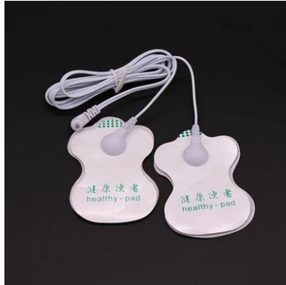
Gambar 2.2 Elektroda jenis floating[15]
