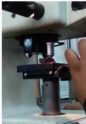
Gambar 4.12 Proses Pengujian Kekerasan Vickers
