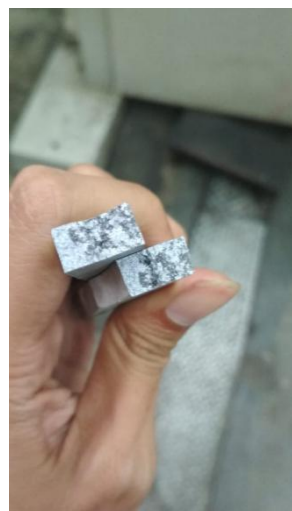
Gambar 4.2. Hasil Patahan Pada Spesimen Yang Tidak Sempurna Campurannya
