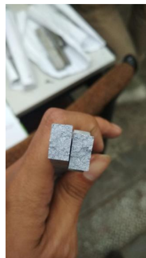
Gambar 4.3. Hasil Patahan Pada Spesimen Yang Sempurna Campurannya
