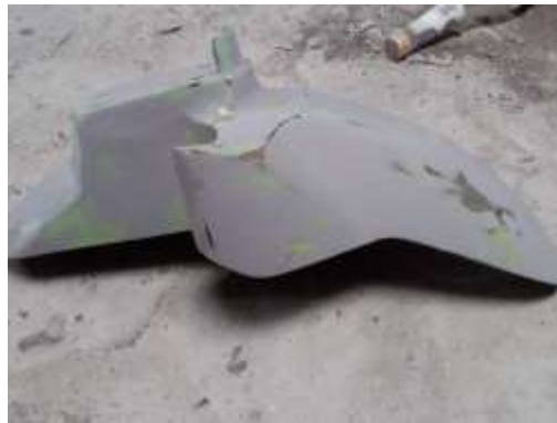
Gambar 4. 11 Hasil pengamplasan spakbor
