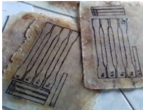
Gambar 3. 12 Hasil Akhir Pembuatan Spesimen Dan Digambar Bentuk Spesimen
