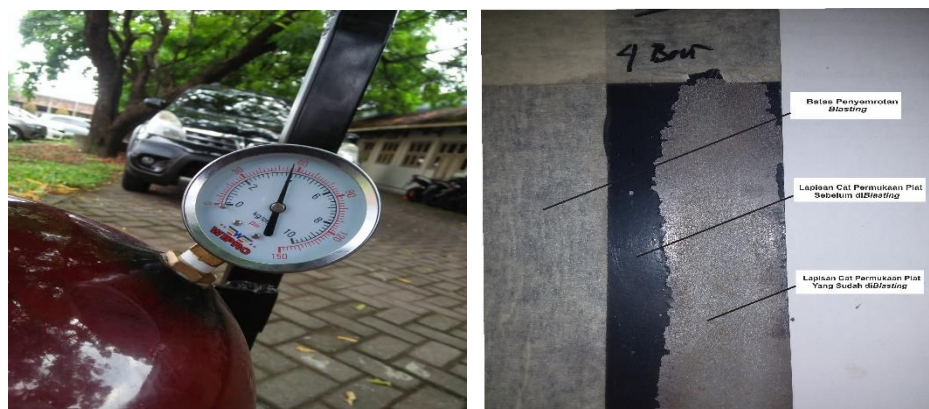
Gambar 4.7 Tekanan 4 Bar dan Permukaan Pelat Yang Sudah diBlasting
