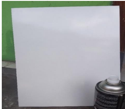
Gambar 4.4 Pengecatan Plat dengan epoxy surfacer
