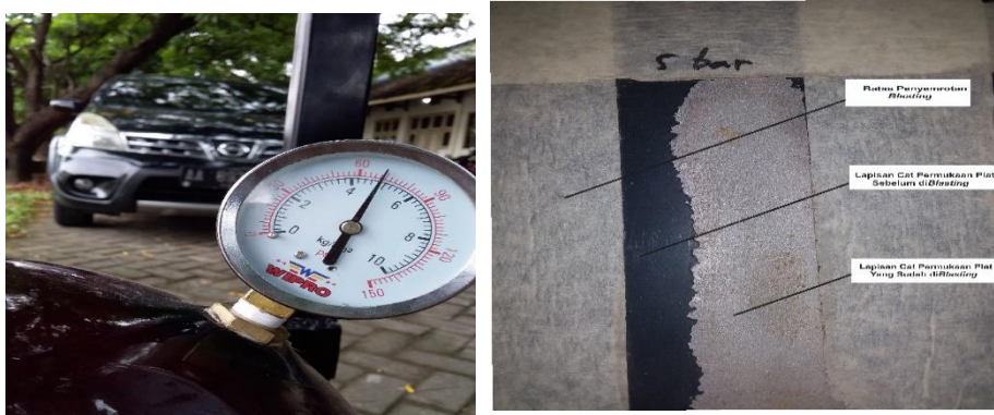
Gambar 4.8 Tekanan 5 Bar dan Pelat Yang Sudah di Blasting
