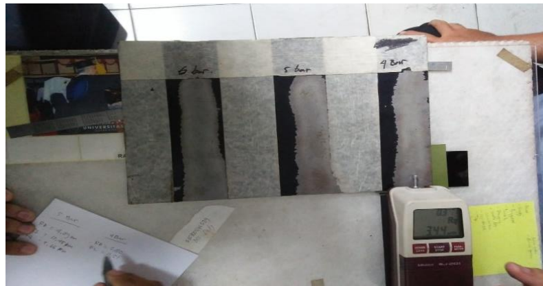
Gambar 4.11 Pengujian Kekasaran Permukaan Dengan Surface Roughness Tester Mitutoyo SJ-201 .
