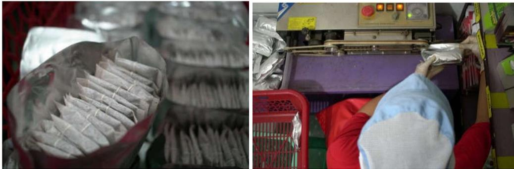
Gambar 10. Proses Memasukkan *Tea Bag* ke dalam *Foil* dan *Sealing Foil*
