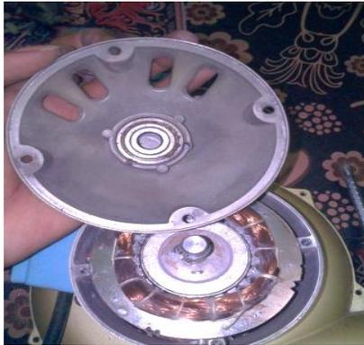
Gambar 3.12 *Stator* dan *rotor* motor listrik blower.
