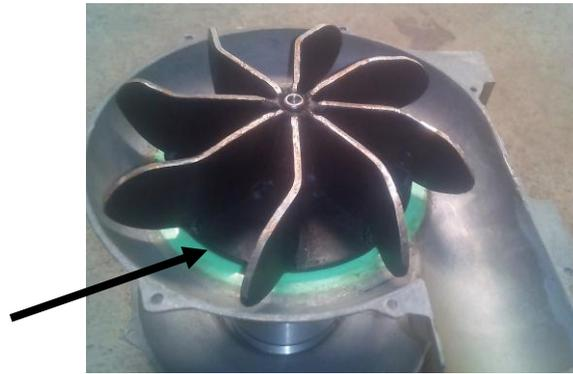
Gambar 3.15 Penutup lubang ke ruang motor penggerak.
