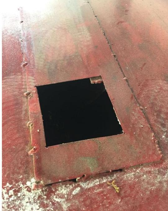
Gambar 4.5 Lubang input sebagai tempat masuknya adonan dari mesin pencacah di atasnya.
