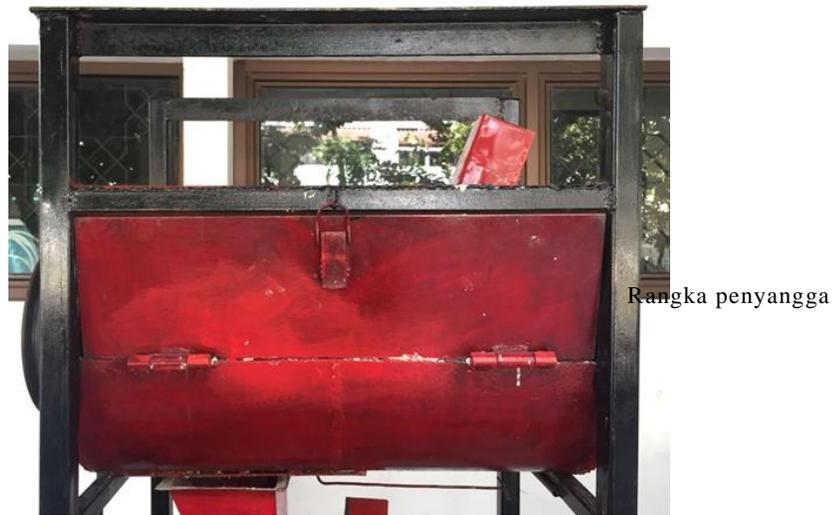
Gambar 4.4 Rangka Penyangga Mesin *Mixing*
