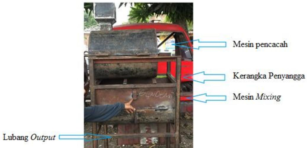
**Gambar 3.22** Komponen mesin *mixer* bahan baku pelet ikan lele
