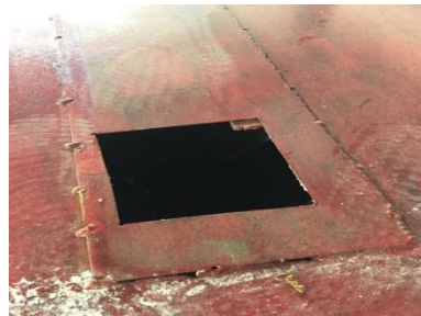
Gambar 4.5 Lubang input sebagai tempat masuknya adonan dari mesin pencacah di atasnya.
