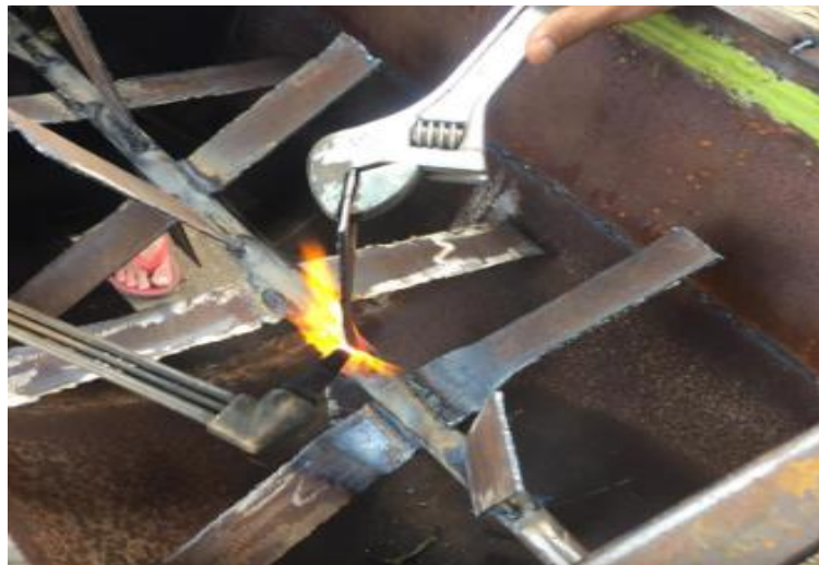
Gambar proses pembekongan lengan pengaduk
