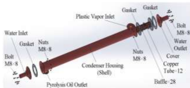
Gambar 2.4 Kondensor Rancangan Darlami, H. B., dkk (2017)
