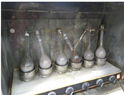
Tahap Destruksi kadar N Total
