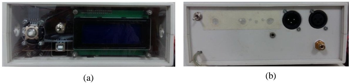
Gambar 3.18. Kontroler Antena Penjejak, (a) tampak depan (b) tampak belakang
