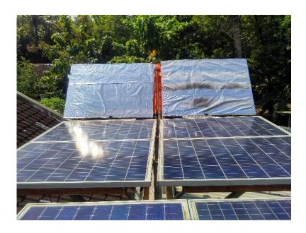
Gambar 4.5 Panel Surya dengan Reflektor Alumunium Foil
