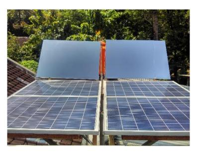
Gambar 4.4 Panel surya dengan Reflektor Cermin Datar
