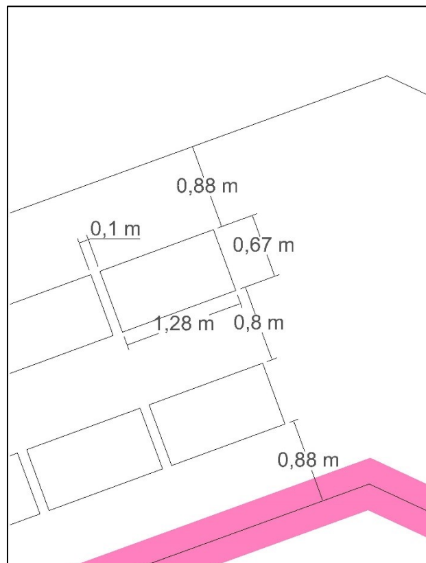
Gambar 2. Layout Posisi Panel Photovoltaic dengan antar panel dan batas atap.
