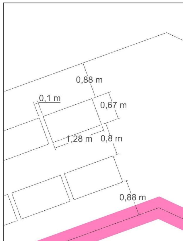
Gambar 4.5. Layout Posisi Panel *Photovoltaic* dengan Sekitarnya (antar panel dan batas atap).
