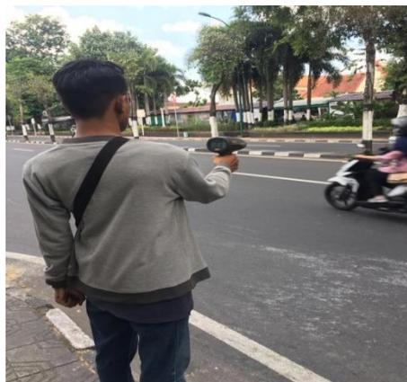
Gambar 3.8 Survei kecepatan kendaraan dengan *speedgun*
