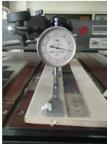
Gambar 3.8 Pengukuran cacat sinkmark longitudinal
