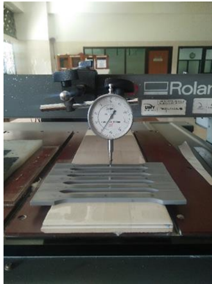
Gambar 3.9 Pengukuran cacat sinkmark transversal
