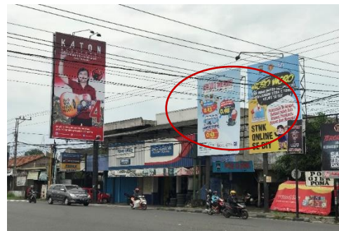
Gambar 4.4 Baliho yang terlalu dekat dekat dengan tiang listrik
