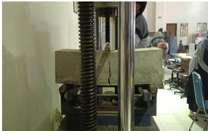
Gambar 2 Pengujian kuat lentur beton
