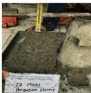
Gambar 4.1 Hasil slump test pada campuran beton.
