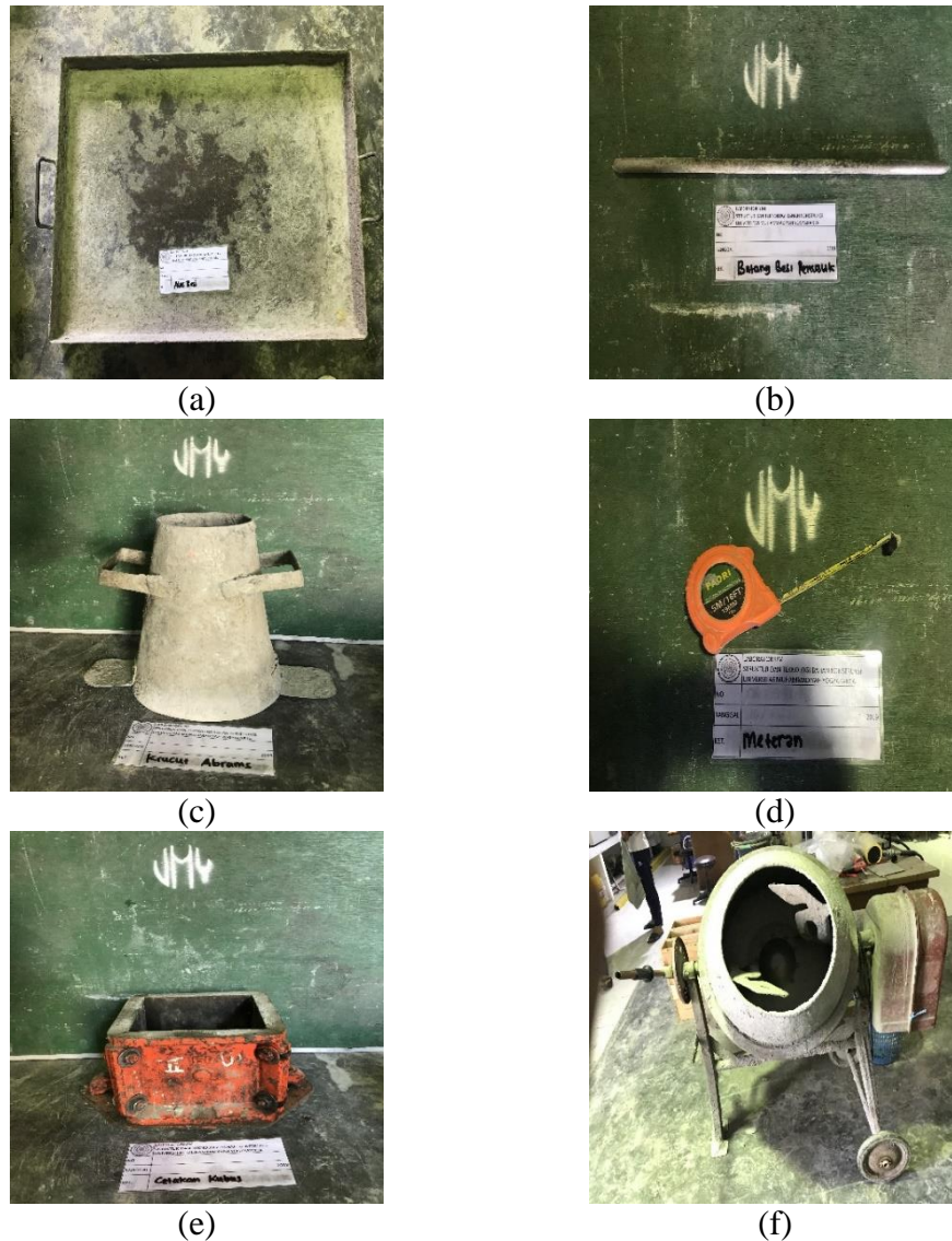
Gambar 3.3 Alat uji slump dan pembuatan beton (a) alas besi, (b) besi penusuk, (c) krucut abrams , (d) meteran, (e) cetakan kubus, dan (f) concrete mixer .
