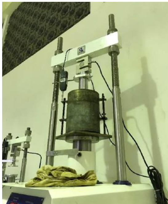
Gambar 3.9 Alat Uji CBR
