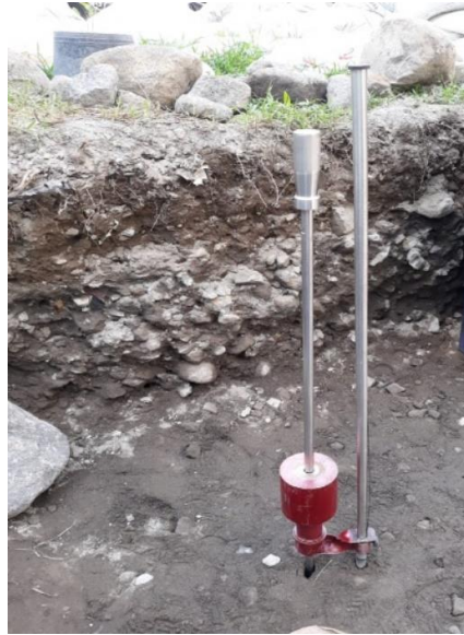
Gambar 3.21 Posisi alat DCP pada titik pengujian
