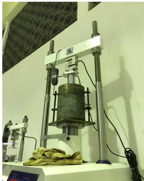
Gambar 3.8 Alat uji CBR
