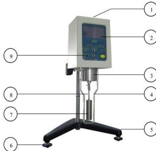
Gambar 3.26 Rangkaian Penyangga dan Viscometer NDJ 8S
