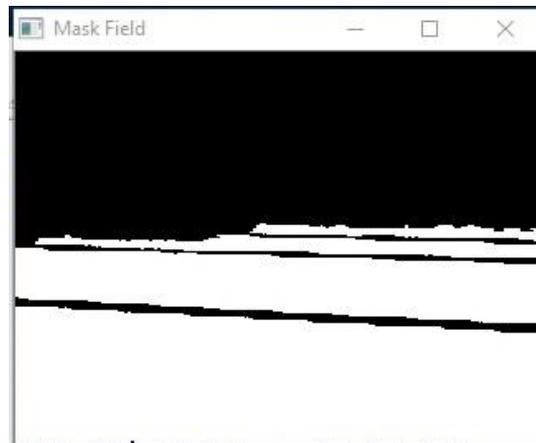
**Gambar 4.17** Hasil Proses *Masking* Warna Lapangan
