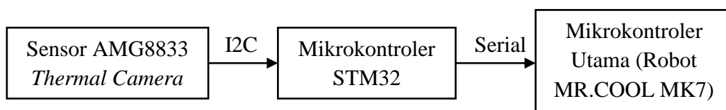
Gambar 3.2 Blok Diagram Sistem Deteksi Api
