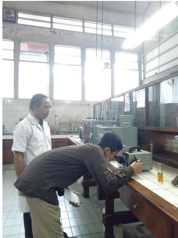
Pengujian Jenis Warna Minyak Isolasi Bekas Transformator
