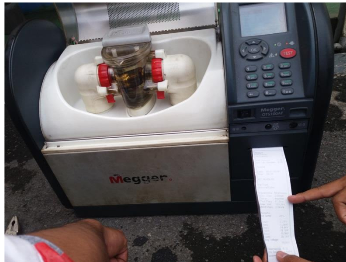
Pengujian Tegangan Tembus Minyak Isolasi Bekas Transformator
