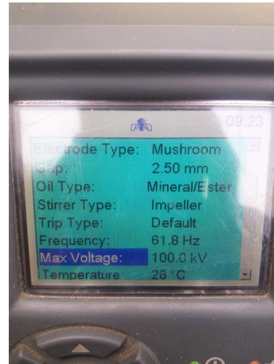
Tampilan Layar Megger Saat Pengujian Tegangan Tembus
