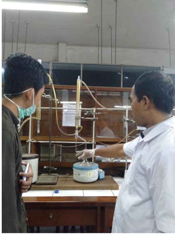
Pengujian Kandungan Air Minyak Isolasi Bekas Transformator
