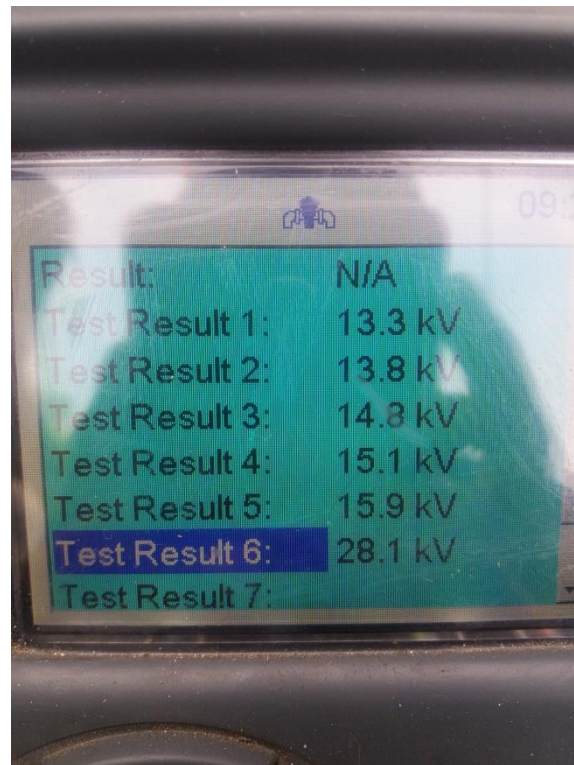
Tampilan Layar Megger Saat Pengujian Tegangan Tembus
