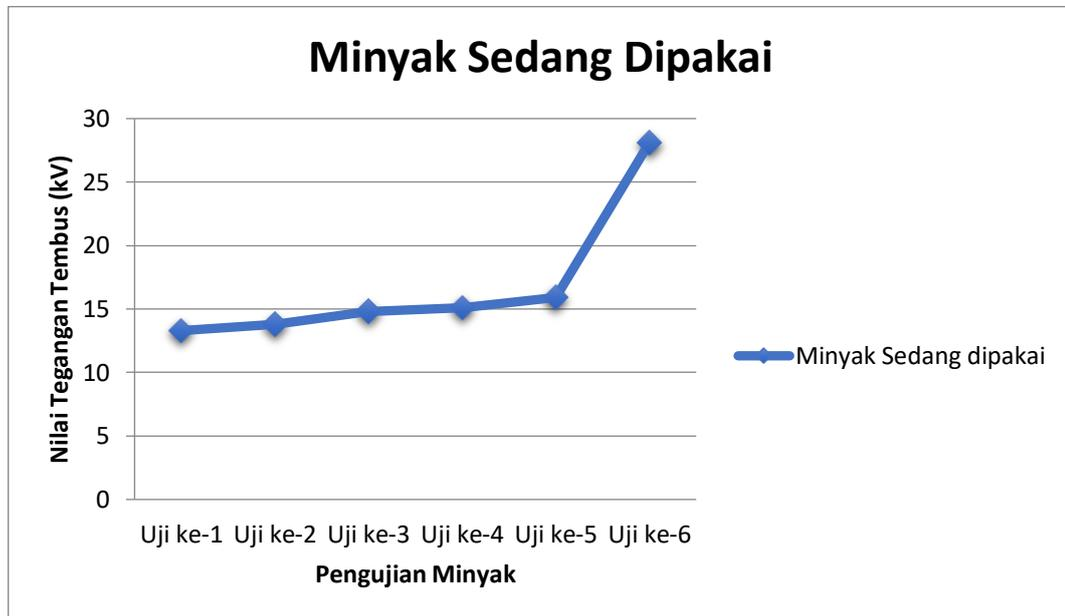
**Gambar 4.3 Kurva Nilai Tegangan Tembus Minyak Bekas Dipakai dengan Suhu Tetap 26°C**
