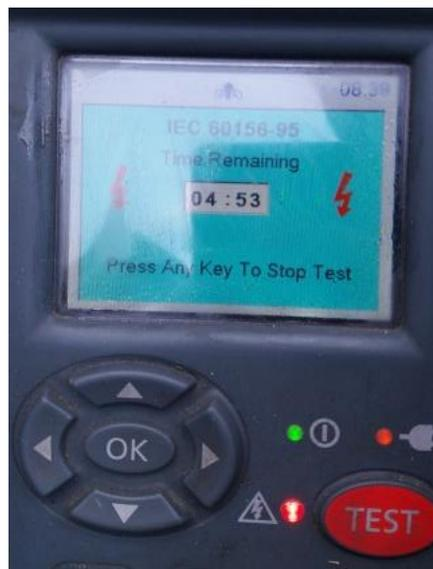
**Gambar 3.26 Tampilan Saat Pengujian Tegangan Tembus**
