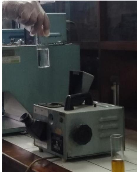
**Gambar 3.12 Peletakan Sampel Minyak**
