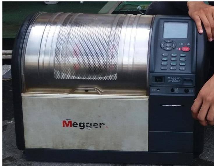
**Gambar 3.5 Instrumen Penguji Tegangan Tembus Megger OTS 100AF**
