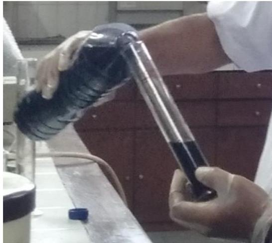
**Gambar 3.14 Penuangan Sampel Minyak ke Dalam Gelas Ukur**
