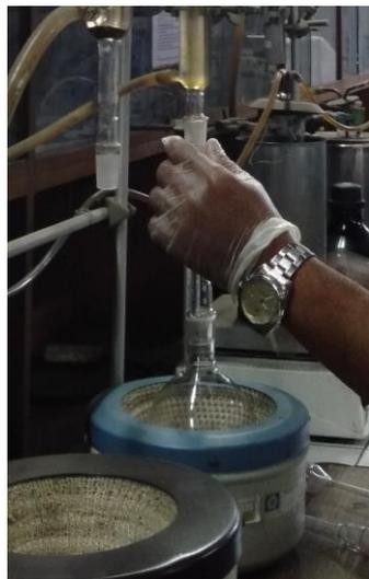
**Gambar 3.19 Pemanasan Sampel Minyak dengan Campuran Bahan Kimia**
