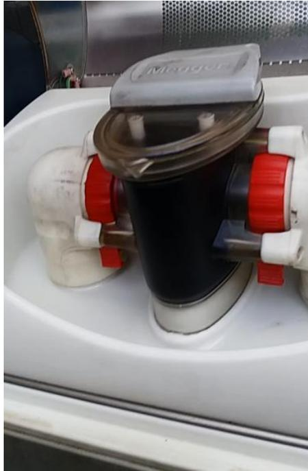
**Gambar 3.21 Gelas Uji Tegangan Tembus**
