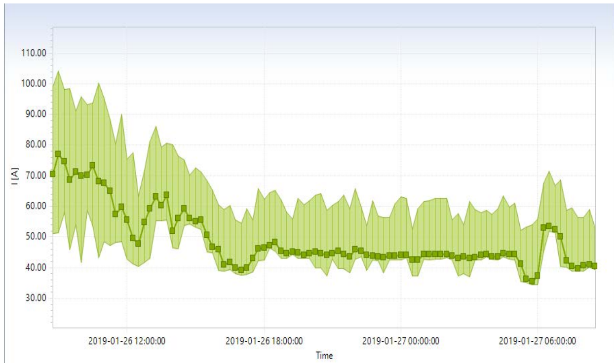
Gambar 4.11 Grafik Nilai Arus Fasa T Hasil Pengukuran Panel SDP E7 di UMY
