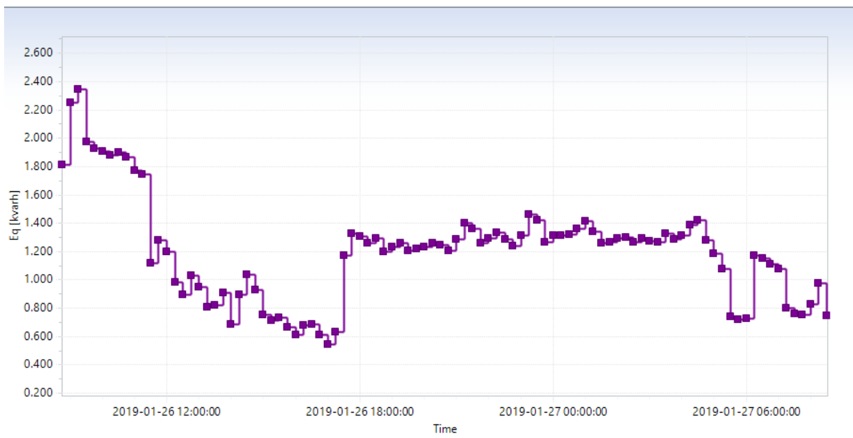
Gambar 4.22 Grafik Nilai Daya Reaktif Aktif Fundamental Hasil Pengukuran Panel SDP E7 di UMY
