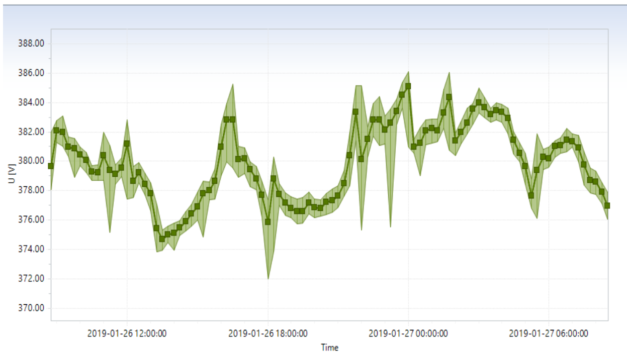
Gambar 4.4 Grafik Nilai Tegangan Fasa T Hasil Pengukuran Panel SDP E7 di UMY
