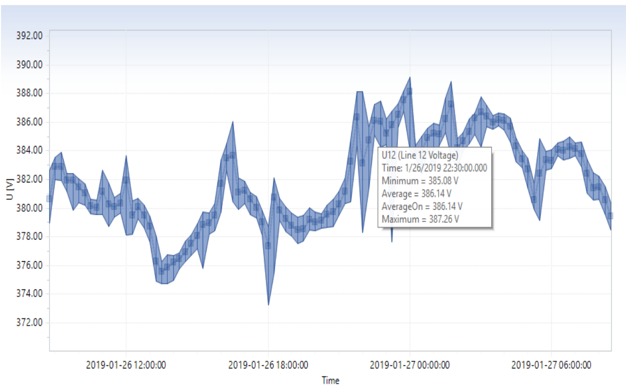
Gambar 4.2 Grafik Nilai Tegangan Fasa R Hasil Pengukuran Panel SDP E7 di UMY
