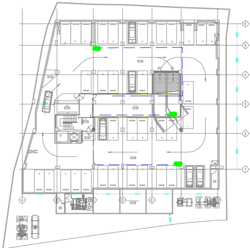
Gambar 15 hasil perancangan kotak – kontak lantai basement
