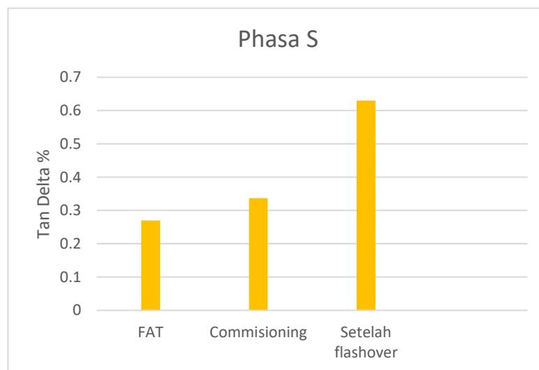
**Gambar 4. 3 Grafik Pengujian Tangent Delta pada phasa S**
