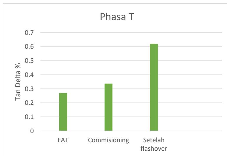
**Gambar 4. 4 Grafik Pengujian Tangent Delta pada phasa T**
