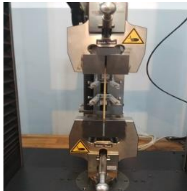
Gambar 3.6 Material uji yang sudah dipasang pada Mesin Uji Tarik.
