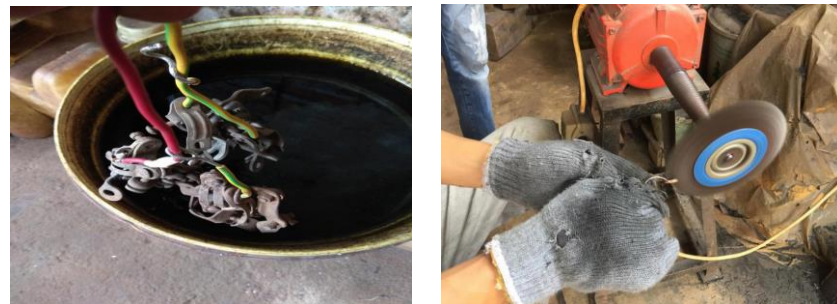
Gambar 3.2. (a) Proses pencucian benda kerja, (b) Pemolesan benda kerja
