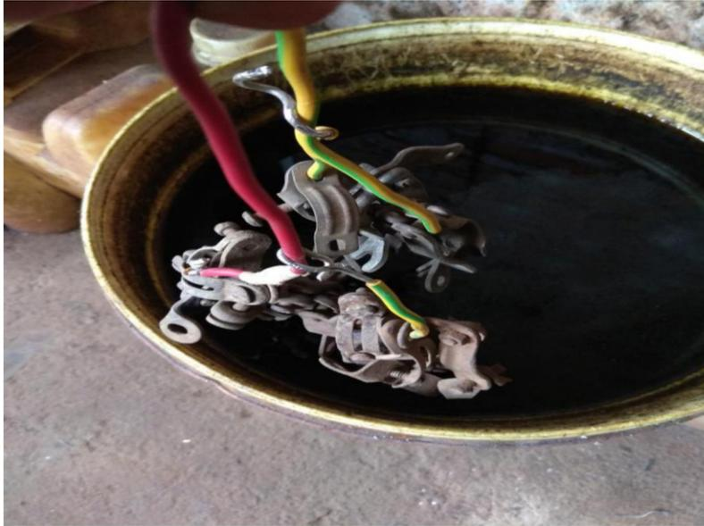
Gambar 3.3. Proses pencucian benda kerja dengan air dan sabun
