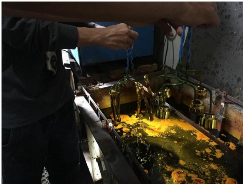
Gambar 3.6. Proses pencelupan benda kerja pada cairan *chrome*
