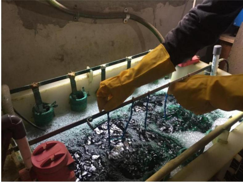
Gambar 3.5. Proses pencelupan benda kerja pada cairan *nickel*
