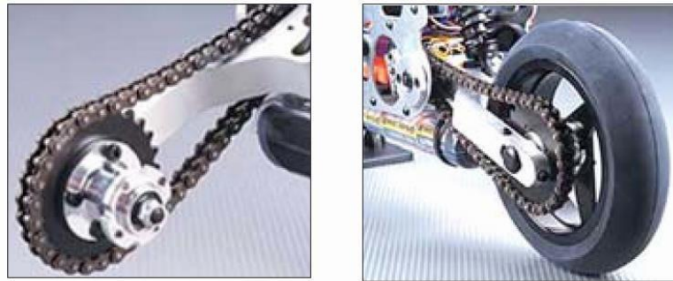
Gambar 2.23 Bush roller chain pada sepeda motor (R.S. Khurmi dan J.K. Gupta, 2005)
